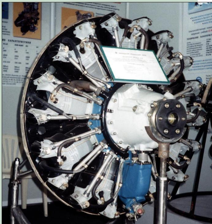
Авиационный поршневой, четырехтактный двигатель воздушного охлаждения М14П предназначен для установки на спортивно-акробатических самолетах Су-26М.
